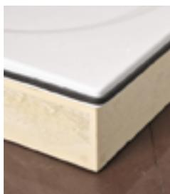
**1.** По бокам поддона/ванны, прилегающим к стене, на расстоянии 10 мм от верхнего края приклейте самоклеющуюся пористую ленту. Это необходимо для удержания герметика и придания дополнительной шумоизоляции.
