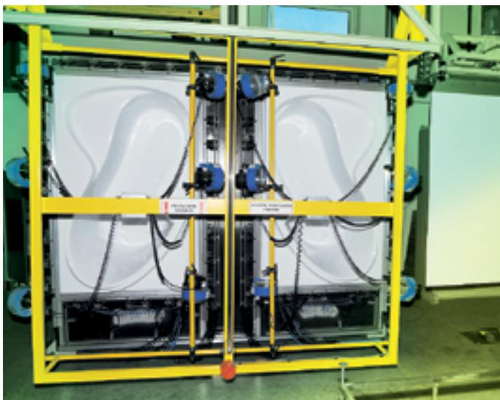
Формовка будущих ванн производится с использованием технологий вертикального нагрева
