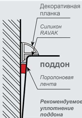
**Неаккуратное соединение поддона со стеной легко исправить: в зазор между поддоном и стеной можно вставить планку, с помощью которой Ваша работа станет действительно профессиональной.**
