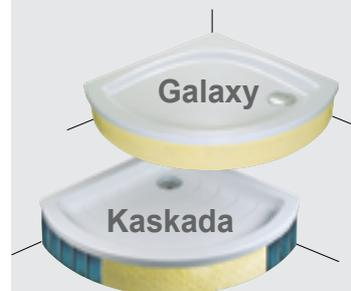
Поддоны типа EX состоят из акриловой формы и полиуретанового носителя. От поддонов типа PU отличаются тем, что поддон типа EX обрезают так, чтобы его можно было облицевать кафелем. В таком случае облицовка клеится непосредственно к поддону. Не каждый профессионал в состоянии безошибочно сделать каркас и после этого облицовку круглой формы. Но даже новичок сможет облицевать полиуретановый носитель керамической плиткой.
