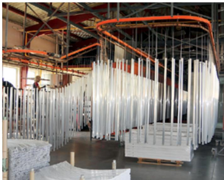
Электростатическое нанесение порошковой краски на профили душевых уголков, дверей и шторок для ванн.
