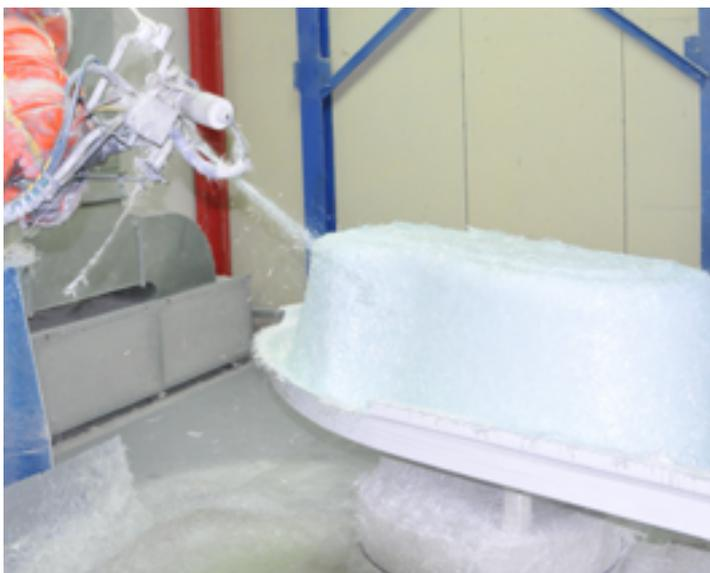
Это способ укрепления акриловых ванн стекловолокном. Соотношение компонентов и их количество контролируется компьютером для каждого типа ванн отдельно. Преимущества ламината - высокая прочность и жесткость готовой продукции по доступной цене.
