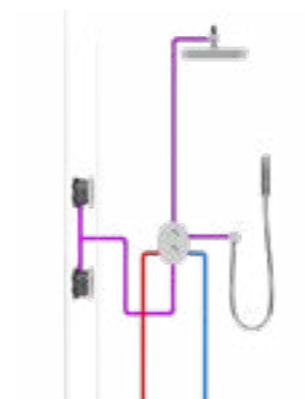
Вывод для ручного и верхнего душа в сочетании с макс. 2-мя душевыми форсунками.
